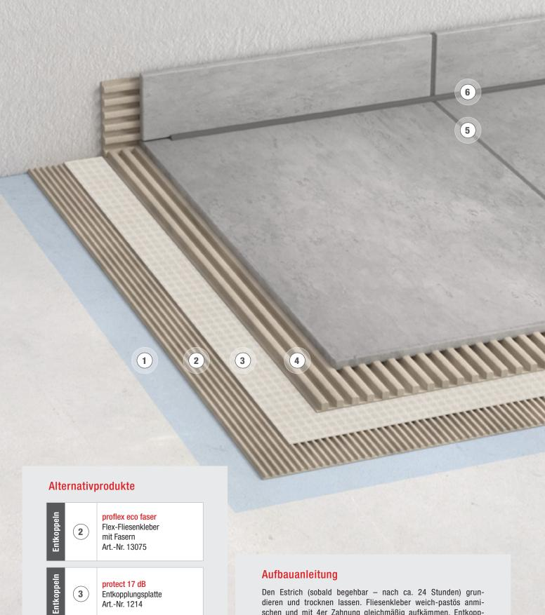
Den Estrich (sobald begehbar – nach ca. 24 Stunden) grundieren und trocknen lassen. Fliesenkleber weich-pastös anmischen und mit 4er Zahnung gleichmäßig aufkämmen. Entkopplungsbahn in das frische Mörtelbett einlegen und mit einem Glätter vollflächig andrücken. Vor dem Verlegen der Bodenfliesen muss der Klebemörtel abgebunden sein.
